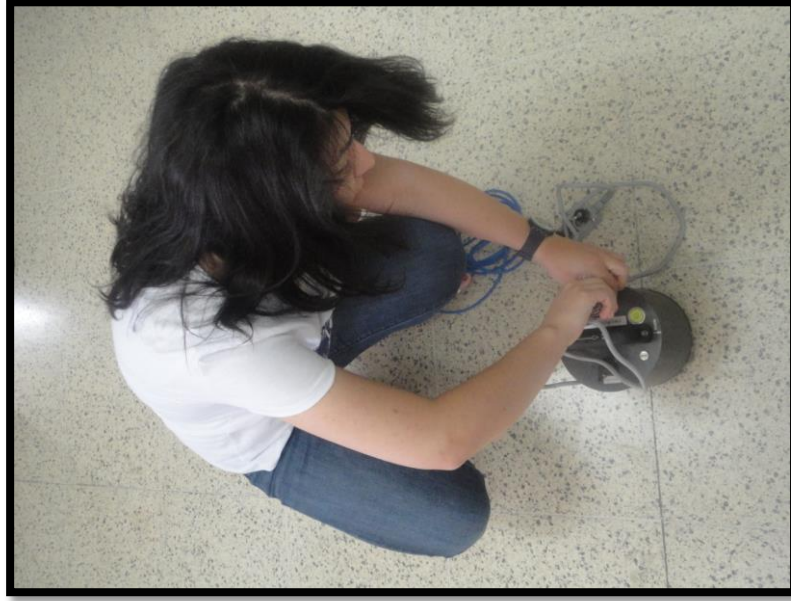
Şekil 2. CMG-6TD Hız Ölçer Sismometre ile Ölçü Alımı (Örnek)
