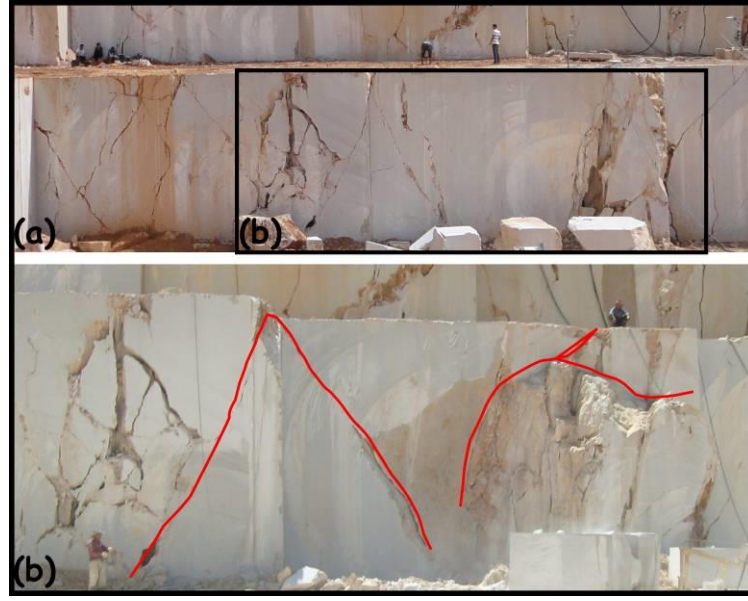
Şekil 2 a) 1. Alan 1. profil (Şekil 1) deney bloğunun düşürülmeden önce gözlemlenen ayna, b) Kesimi yapılan aynanın sökümü yapıldıktan sonraki görünümü
